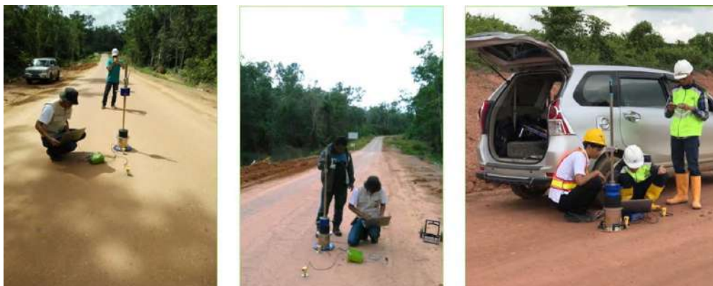
Gambar 4. Contoh Pengujian dengan LWD
